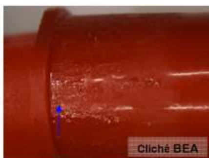
Cliché 3 : Bouton rouge Traces d'un produit à l'apparence gras
