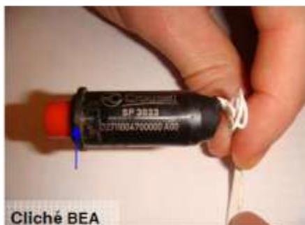
Cliché 1 : Vue d'ensemble Traces de dépôts sur manchon noir
