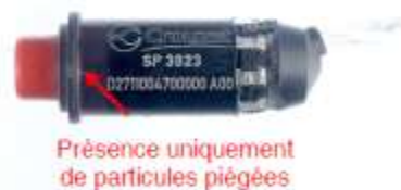
Cliché 2 : Vue d'ensemble absence des dépôts observés chez Ratier-Figeac sur manchon noir
