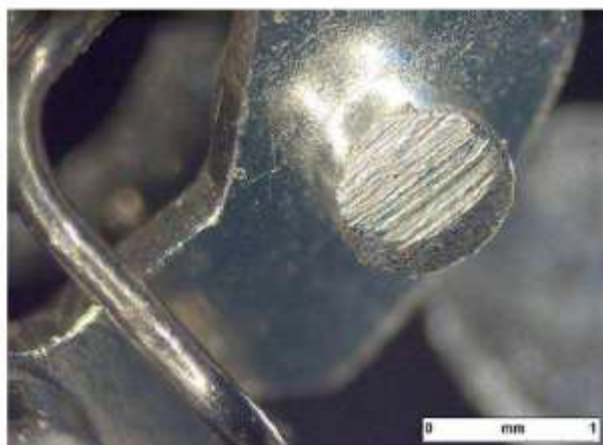
Cliché 9 : Autre plots de contact Exemple de stries observées»
