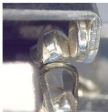
Cliché 6 : plots de contact Absence de particules
